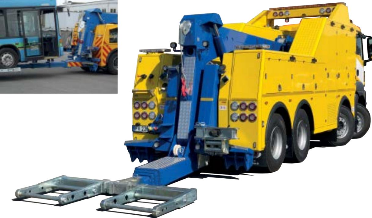
L'allestimento **FP 8000** è il più grande della famiglia, dotato di una forca posteriore idraulica da 8 ton a 3 sfilì e da un braccio gru da 15 ton permette il recupero e il traino di mezzi pesanti. Le carenature interamente in alluminio sono completamente personalizzabili, è anche possibile montare verricelli extra per una migliore capacità di intervento sul posto. Applicabile su veicoli con massa complessiva da 26 a 32 Ton.
