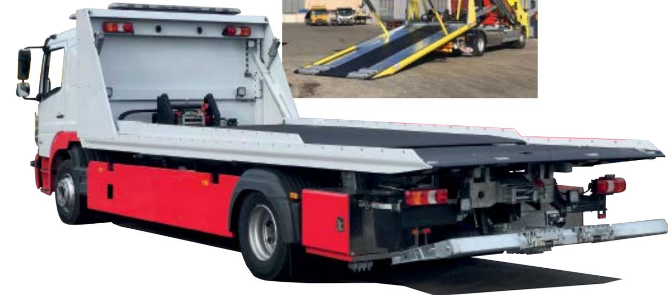
L'allestimento **DPV 200**, grazie al suo doppio pianale, è in grado di trasportare o soccorrere ben due veicoli per volta. Disponibile nella versione a 2 o 4 cilindri si adegua ad ogni esigenza del cliente con pianali in acciaio o completamente in alluminio (DPA200). Il suo doppio movimento consente di gestire al meglio il carico e lo scarico delle vetture. Questo allestimento è applicabile su veicoli da 12 a 26 ton.
