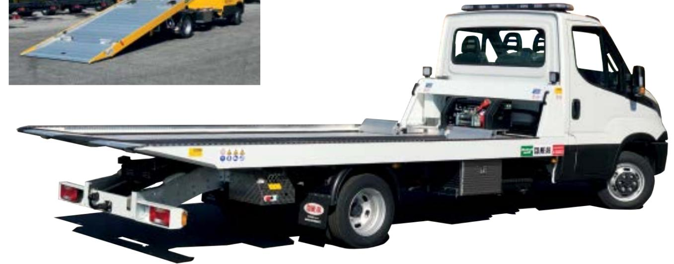
L'allestimento **CITY STAR** è famoso per la sua facilità d'intervento in qualsiasi situazione, per un soccorso veloce alla portata di tutti, applicabile su telai da 3,5 a 5 ton di massa complessiva e prodotto nella versione **CLASSIC** e **NEW** in funzione del veicolo da allestire.
