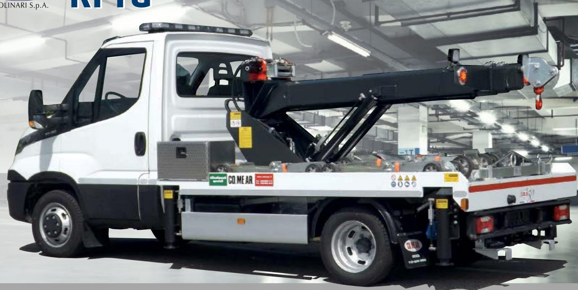
L'allestimento **RFTG** rappresenta la soluzione ottimale per la rimozione di veicoli, grazie al suo braccio gru girevole con doppio sfilo idraulico. Disponibile con forca posteriore con apertura e chiusura automatica (RFTG 020) è famosa per la sua estrema facilità e velocità d'intervento in qualsiasi situazione, in grado di rimuovere una vettura in sosta o in avaria in un lasso di tempo minimo. Applicabile su veicoli con massa complessiva da 5 a 10 Ton.
