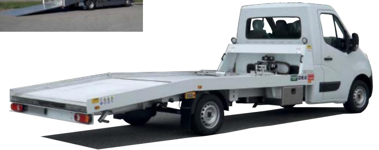
L'allestimento **PFA** è facile nell'utilizzo e veloce in qualsiasi situazione. Da questa struttura si sono sviluppate diverse sottocategorie per il trasporto di vetture, per il trasporto di mezzi pesanti o cingolati, addirittura allestimenti dedicati al trasporto chiuso di prototipi o veicoli unici nel loro genere. Disponibile su veicoli on massa complessiva da 3,5 a 18 ton.
