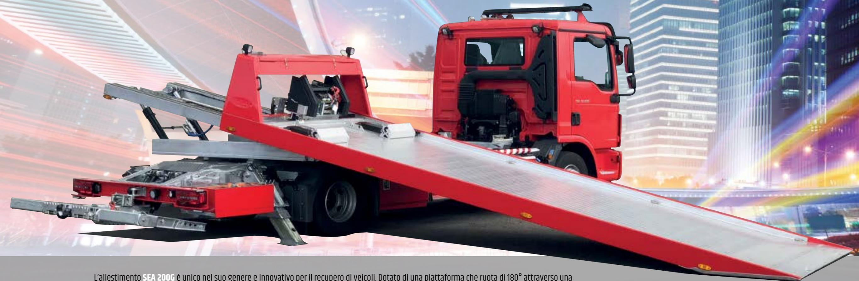
L'allestimento **SEA 200G** è unico nel suo genere e innovativo per il recupero di veicoli. Dotato di una piattaforma che ruota di 180° attraverso una ralla e motoriduttore idraulico può recuperare i veicoli con estrema facilità in situazioni di ridotto spazio di manovra, facilitando il recupero oltre fossati, guardrail o dislivelli. Disponibile nella versione con pianale in acciaio zincato a caldo "SE200G" è applicabile su veicoli da 12 a 18 ton.
