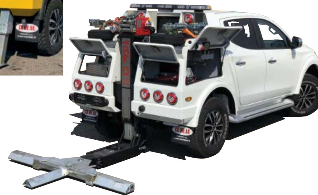
L'allestimento **RF 010** è la soluzione ideale per il Depannage. La forca posteriore con apertura e chiusura automatica è famosa per la sua estrema facilità e velocità d'intervento in qualsiasi situazione, in grado di rimuovere una vettura in sosta o in avaria senza scendere dal veicolo. Applicabile su Pick-up con massa complessiva di 3,5 Ton.
