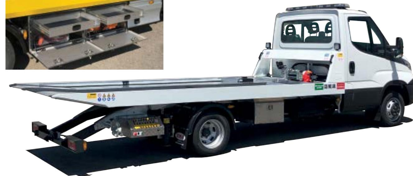
L'allestimento **MG 200** è l'evoluzione dello storico S.C.E.A, veloce e robusto permette di scarrare il pianale con un solo movimento, è inoltre possibile applicare un braccio gru da 2 Ton e una forca posteriore da 1,5 ton. Applicabile su veicoli con massa complessiva da 5 a 7 ton.
