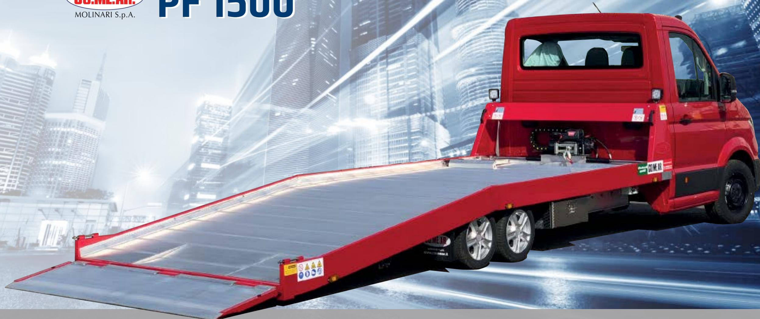
L'allestimento **PF 1500** è perfetto per il trasporto di vetture, dotato di un telaio completamente in lega di alluminio e di un Doppio assale posteriore OMOLOGATO permette di avere una portata utile di Kg 1200. L'altezza da terra ridotta e gli assali abbassabili a terra permettono di ridurre l'inclinazione e poter caricare con facilità vetture con assetto sportivo e supercar. Applicabile su telai con massa complessiva di 3,5 ton.
