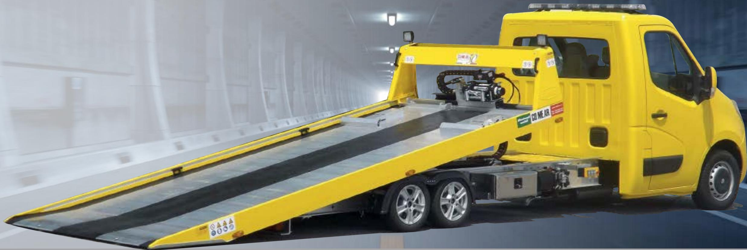
L'allestimento **SP 1250** è un ibrido tra CITY STAR e PF1500, dotato di un telaio completamente in lega di alluminio, di un Doppio assale posteriore OMOLOGATO permette di avere una portata utile di Kg 1100. Grazie alla piattaforma scarrabile è adatto al soccorso stradale, allo stesso tempo ottimo per il carico di vetture con assetto sportivo. Applicabile su telai con massa complessiva di 3,5 Ton.
