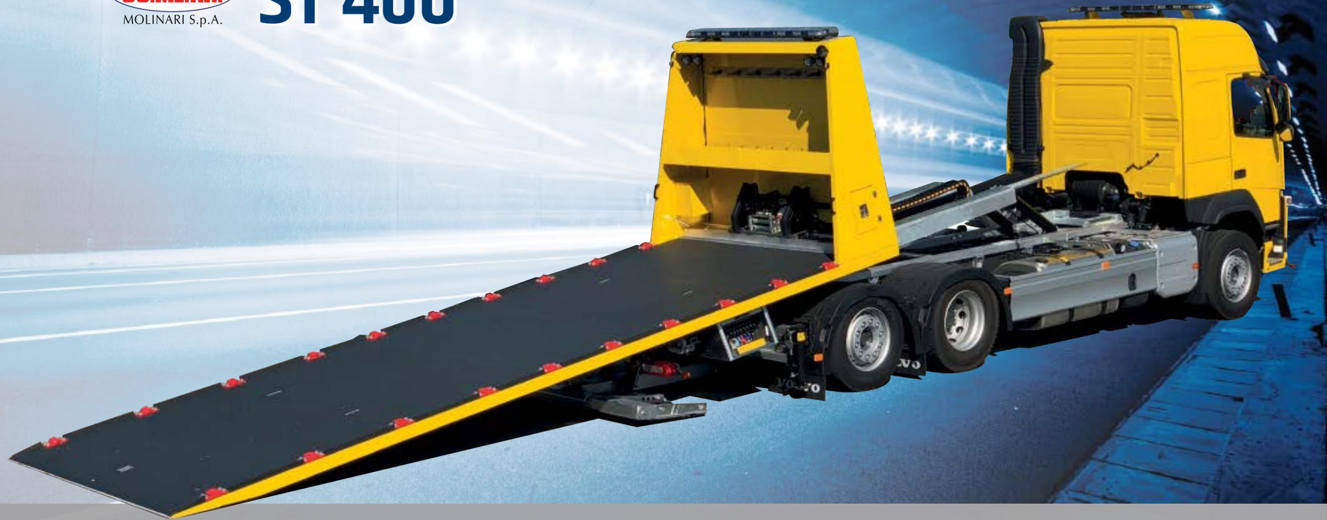
L'allestimento **ST 400** è inarrestabile, con la sua superstruttura è in grado di caricare veicoli con pesi elevati senza il minimo sforzo. Le doppie guide in acciaio permettono di eseguire lavori che risultano essere rischiosi per altri allestimenti. Questa struttura può montare forche da 4 o da 6 Ton per il soccorso di mezzi pesanti. Disponibile nella versione con pianale in lega di alluminio "AL400" è applicabile su veicoli da 18 a 32 ton.
